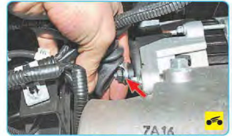
12. Отверните гайку крепления и отсоедините провод от контактного болта генератора.
