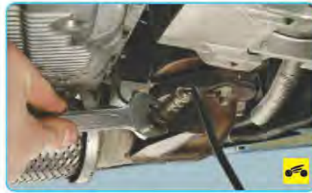
5. Ключом ослабьте затяжку датчика...
