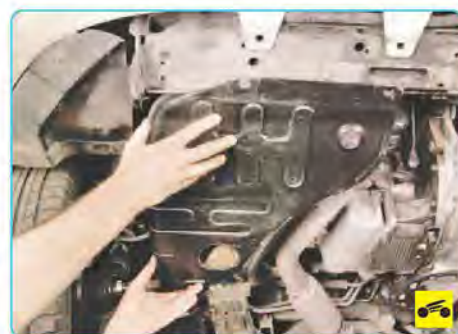
4. ...и, аккуратно поддев подкрылок, снимите левый брызговик двигателя с автомобиля.
