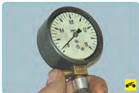
13. ...установите его стрелку на ноль, нажав на клапан выпуска воздуха.
