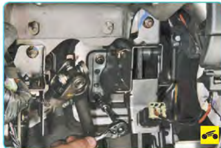
4. Отверните четыре гайки крепления вакуумного усилителя тормозов (см. «Замена вакуумного усилителя тормозов», с. 198), которыми одновременно к щиту передка крепится кронштейн педали тормоза...
