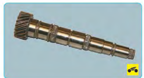
36. Осмотрите вторичный вал и его детали: – на шейках под игольчатые подшипники не должно быть следов усталостных разрушений, а на шлицах для установки муфт синхронизаторов – забоин и смятия;
