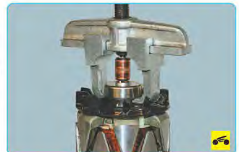
28. ...спрессуйте подшипник с посадочной шейки вала ротора...
