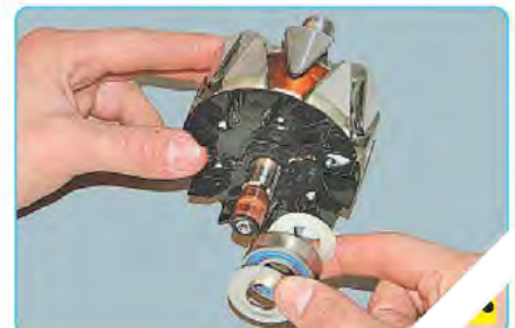
29. ...и снимите подшипник с вала ротора, а также его защитные шайбы.
