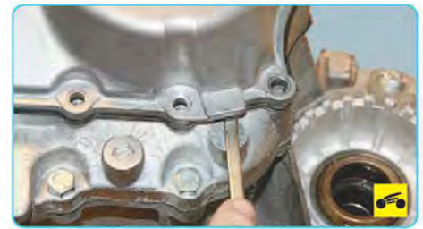
22. Поддев отверткой край крышки в районе специально предназначенного для этого прилива, отделите крышку от прокладки...
