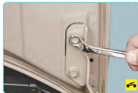
14. Выверните четыре болта крепления капота к петлям (по два с каждой стороны) и снимите капот с автомобиля.
