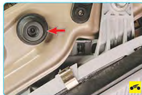
18. Регулируют капот по высоте изменением высоты регулировочных буферов. Высота регулировочного буфера изменяется его вывертыванием или ввертыванием. Регулировочный буфер должен быть установлен так, чтобы поверхность капота совпала с поверхностью крыльев.
