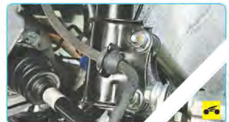
3. Проверьте, нет ли утечки жидкости из соединений тормозных трубок со шлангами передних тормозных механизмов.
