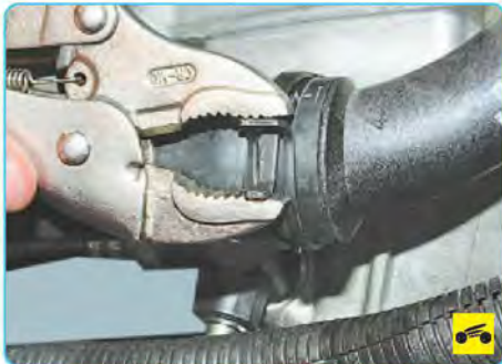
13. Сожмите усики хомута крепления отводящего шланга радиатора системы охлаждения к водораспределительной трубе, сдвиньте хомут по шлангу...
