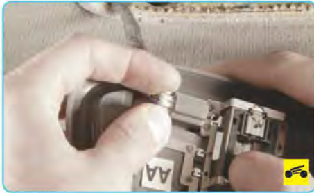
6. Нажмите на фиксатор, отсоедините колодку жгута проводов от разъема плафона и снимите плафон.
