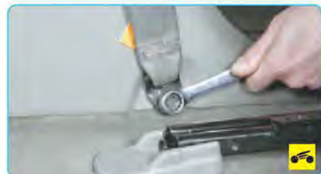
2. Выверните болт нижнего крепления ремня...
