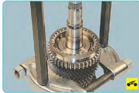
14. Спрессуйте со шлицев вала синхронизатор I и II передач вместе с ведомой шестерней II передачи, прикладывая усилие к торцу шестерни...
