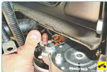
9. ...и отсоедините провод от контактного болта тягового реле.
