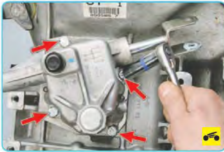
12. Выверните четыре болта крепления корпуса механизма переключения передач...
