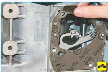
14. ...и установленную под ним прокладку (если она осталась на картере коробки передач).
