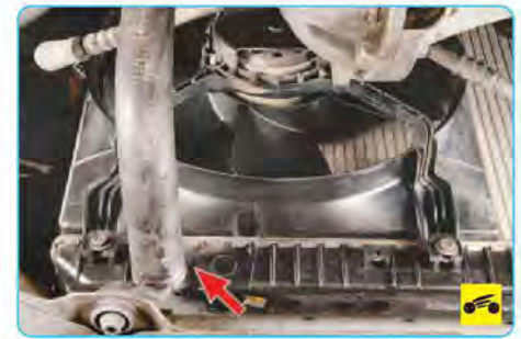
2. Осмотрите соединения с радиатором отводящего...
