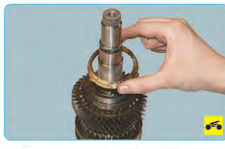
17. ...внутреннее блокирующее кольцо синхронизатора II передачи...
