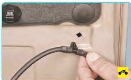
6. ...извлеките соединитель шланга из отверстия в усилителе капота и отведите шланг в сторону.
