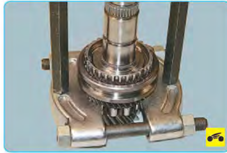
28. Спрессуйте со шлицев вала синхронизатор III и IV передач, прикладывая усилие к торцу ведомой шестерни IV передачи.
