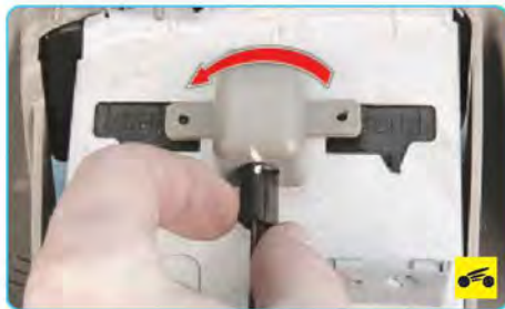
14. Поверните на 90° против часовой стрелки патрон лампы подсветки передней пепельницы...
