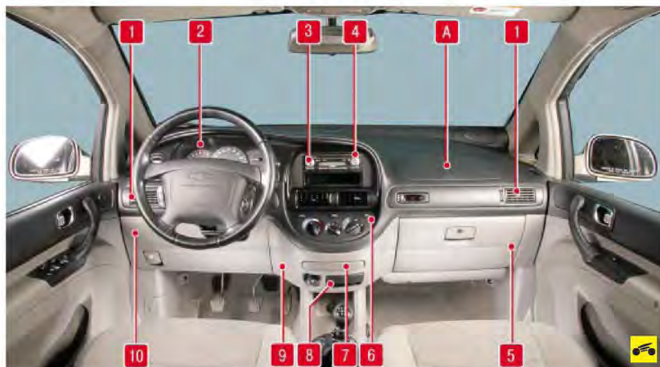
Рис. 11.1. Панель приборов: А – зона установки подушки безопасности переднего пассажира; 1 – сопла обдува боковых стекол; 2 – комбинация приборов; 3 – аудиосистема; 4 – сопла обдува передних пассажиров; 5 – вещевого ящик; 6 – блок управления системой отопления (кондиционирования) и вентиляции салона; 7 – блок подстаканников; 8 – передняя пепельница; 9 – центральная облицовочная накладка панели приборов; 10 – нижняя декоративная накладка панели приборов
