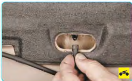
7. Снимите шланги со штуцеров жиклеров омывателя и отведите шланг с тройником в сторону.
