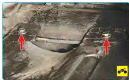
Так расположены болты крепления брызговика двигателя к лонжерону кузова.
