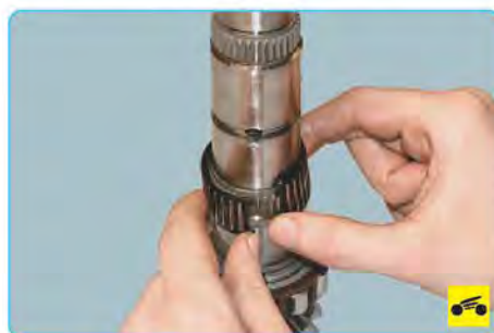
32. ...и разрезной игольчатый подшипник ведомой шестерни IV передачи.
