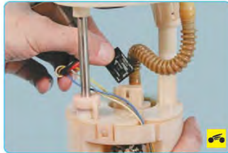
22. ...и отсоедините колодку жгута проводов от разъема топливного насоса.
