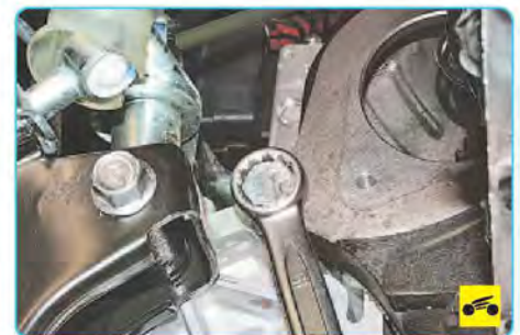
24. Выверните болт крепления картера коробки передач к блоку цилиндров, расположенный сзади около стартера...
