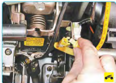
6. Сожмите фиксаторы и отсоедините колодку жгута проводов контактного кольца спиральной токоведущей шины модуля подушки безопасности.
