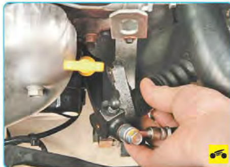
19. ...и отведите цилиндр в сторону, не отсоединяя от него шланг гидропривода.
