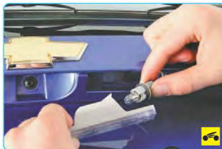
3. Поверните патрон против часовой стрелки и извлеките его из фонаря освещения.
