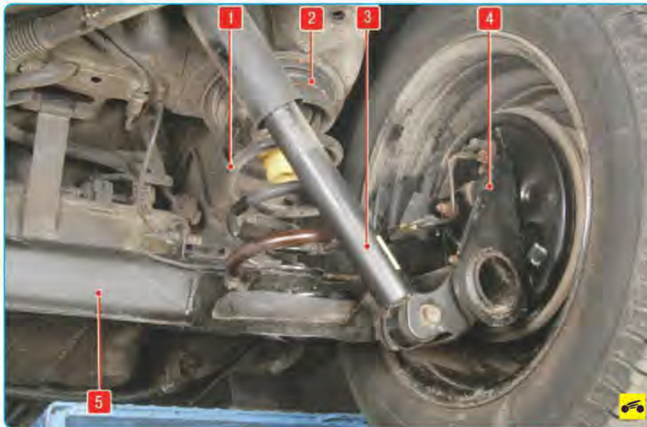
Рис. 7.3. Расположение элементов задней подвески на автомобиле: 1 – пружина задней подвески; 2 – верхняя прокладка пружины; 3 – амортизатор; 4 – кулак; 5 – балка задней подвески
