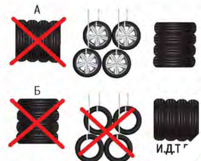
Рис. 14.6. Способы хранения шин: А – хранение колес в сборе с шинами; Б – хранение шин
