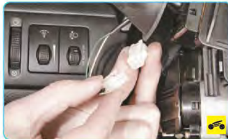
5. ...и разъедините дополнительную колодку жгута проводов переключателя продолжительности паузы между циклами очистителя ветрового стекла.
