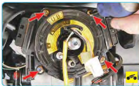
8. Выверните четыре винта крепления спиральной токоведущей шины модуля подушки безопасности водителя к соединителю подрулевых переключателей...
