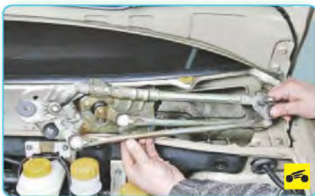
4. ...и выведите моторедуктор в сборе с приводом стеклоочистителя из корпуса воздухопритока.
