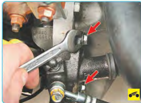
18. Выверните два болта крепления рабочего цилиндра привода выключения сцепления к картеру коробки передач...
