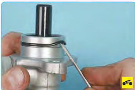
15. Подденьте резиновое уплотнительное кольцо отверткой...
