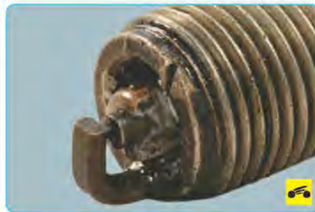
7. Изолятор свечи растрескавшийся или со сколами.
