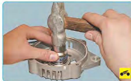
22. Запрессуйте новый подшипник в крышку оправкой подходящего диаметра, прикладывая усилие к наружному кольцу.
