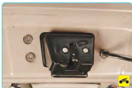
15. Выверните три винта крепления замка двери задка к усилителю двери...
