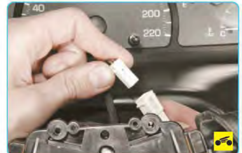
10. ...разъедините дополнительную колодку жгута проводов переключателя указателей поворота и снимите левый подрулевой переключатель.
