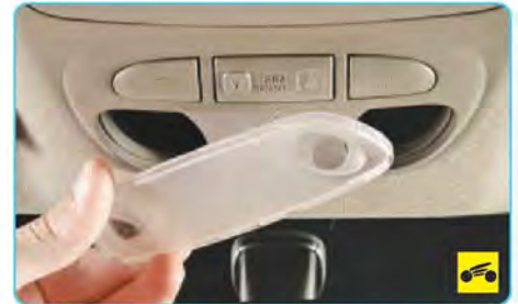
3. ...и снимите рассеиватель плафона, преодолевая сопротивление фиксаторов.
