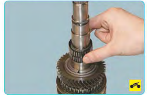
19. Снимите игольчатый подшипник ведомой шестерни II передачи.
