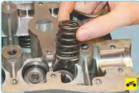
19. ...и извлеките пружину клапана.
