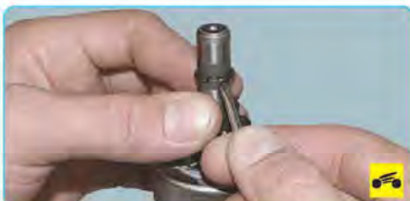
19. Подденьте отверткой и снимите стопорное кольцо.
