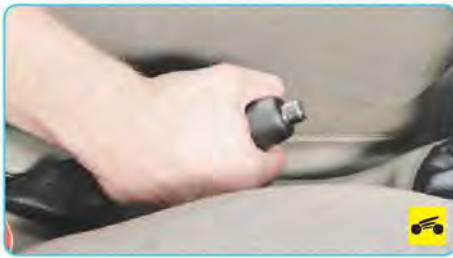
22 – рычаг стояночного тормоза. Для того чтобы затормозить автомобиль стояночным тормозом, поднимите рычаг до упора вверх – в комбинации приборов загорится красный сигнализатор 23 (см. рис. 1.7).
