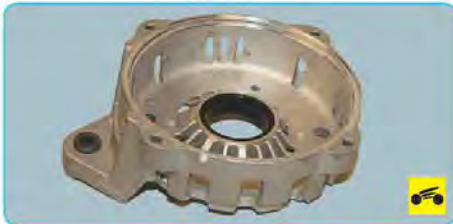
15. Осмотрите крышку со стороны контактных колец. Пластмассовая втулка заднего подшипника ротора генератора должна быть плотно установлена в отверстии крышки. При правильной посадке подшипника во втулке на ней не должно быть следов проскальзывания наружного кольца подшипника. Если обнаружены трещины крышки, особенно в местах крепления генератора, необходимо заменить крышку новой.
