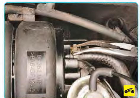
5. ...сожмите отогнутые ушки хомута крепления вакуумного шланга к штуцеру впускной трубы, сдвиньте хомут по шлангу...
