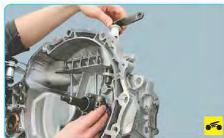
19. ...вилку выключения сцепления (см. «Замена подшипника и вилки выключения сцепления», с. 137)...
