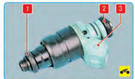
Рис. 5.17. Форсунка системы впрыска топлива: 1 – нижнее уплотнительное кольцо; 2 – верхнее уплотнительное кольцо; 3 – штекерные выводы обмотки электромагнита
