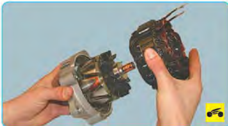
16. Аккуратно поддев статор отверткой, разъедините статор и крышку со стороны привода.
