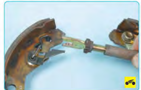
15. Снимите с передней тормозной колодки распорную планку с регулятором...
