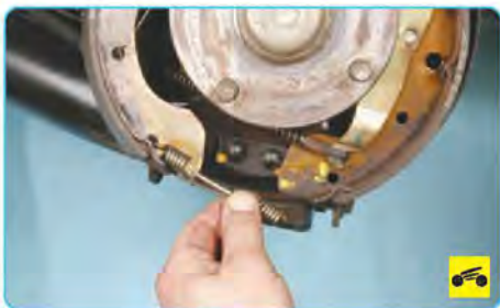
8. Отсоедините нижнюю стяжную пружину от задней и передней колодок тормозного механизма заднего колеса...
