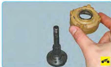
22. Снимите коронную шестерню планетарного редуктора.
