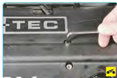
4. Выверните четыре болта крепления декоративного кожуха к двигателю...
