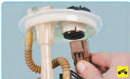
20. ...и отсоедините колодку жгута проводов топливного насоса и датчика уровня топлива от разъема топливного модуля.
