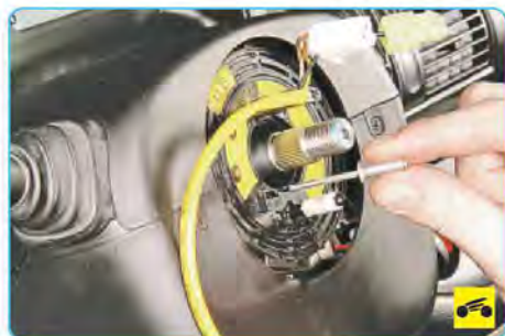
4. Зафиксируйте наружное контактное кольцо спиральной токоведущей шины модуля подушки безопасности водителя относительно внутреннего контактного кольца любым доступным способом, например, штифтом подходящего диаметра.
