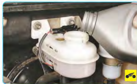
17. Установите главный тормозной цилиндр и все снятые детали в порядке, обратном снятию, залейте тормозную жидкость и удалите воздух из системы (см. «Прокачка гидропривода тормозной системы», с. 194).
