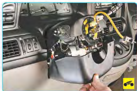
5. Снимите нижний и верхний кожухи рулевой колонки (см. «Снятие и установка кожуха рулевой колонки», с. 183).
