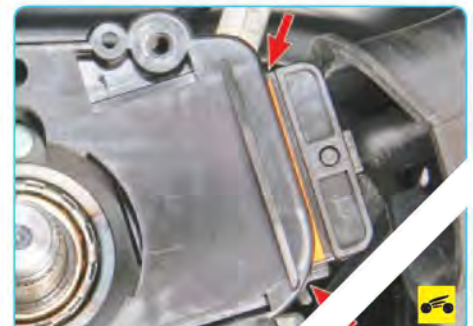
11. Сожмите фиксатор колодки жгута проводов и отсоедините колодку от переключателя.
