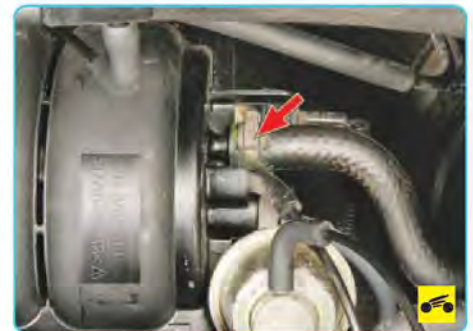
2. ...плотность посадки вакуумного шланга на штуцерах впускной трубы...
