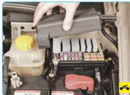
Рис. 10.2. Номера плавких вставок, предохранителей и реле в монтажном блоке, расположенном в моторном отсеке
