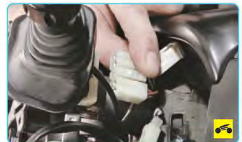
11. Сожмите фиксатор колодки жгута проводов и отсоедините колодку от переключателя.
