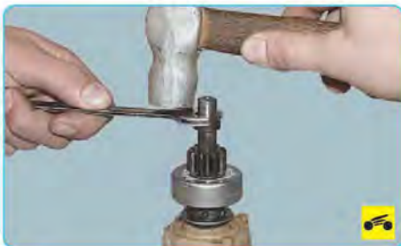
18. Сдвиньте по валу привода ограничительное кольцо, как показано на фото.
