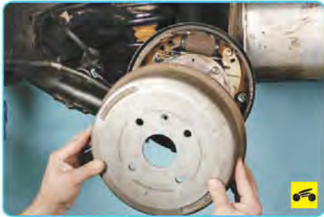
5. Снимите тормозной барабан (см. «Снятие и установка тормозного барабана», с. 204).
