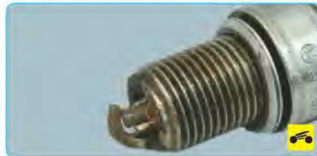
8. Механические повреждения электродов и изолятора свечи.
