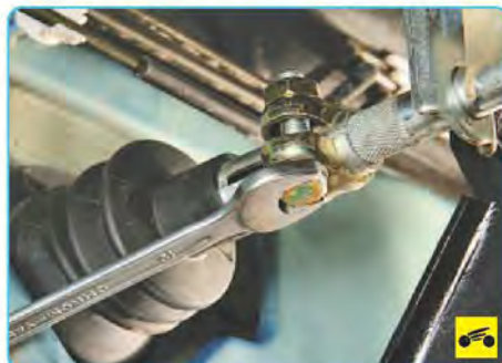
20. Пометьте любым способом (например, краской) взаимное расположение тяги и наконечника рычага переключения передач, чтобы сохранить регулировку привода при обратной установке коробки. Ослабьте затяжку болта клеммового зажима привода управления механизмом переключения передач, разъедините тягу и наконечник рычага переключения передач.
