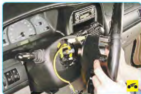
3. Снимите рулевое колесо (см. «Снятие и установка рулевого колеса», с. 183).
