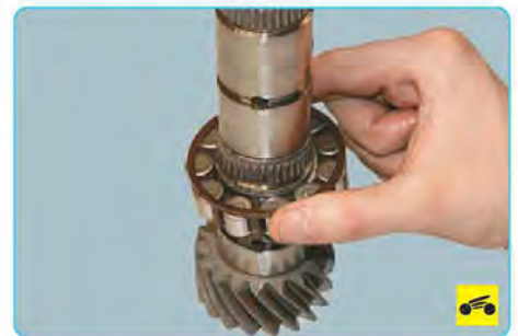
35. ...и задний роликовый подшипник вторичного вала.
