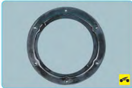
18. ...и уплотнительное кольца. Осмотрите уплотнительное кольцо, обязательно замените его, если оно надорвано или сильно обжато.
