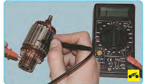
25. Проверьте обмотку ротора на короткое замыкание с помощью омметра. Сопротивление должно стремиться к бесконечности.
