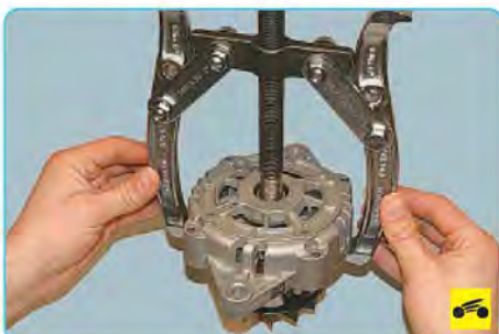
17. Выпрессуйте вал ротора из подшипника крышки со стороны привода...
