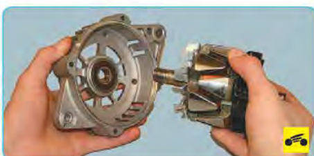
18. ...и разъедините ротор и крышку.
