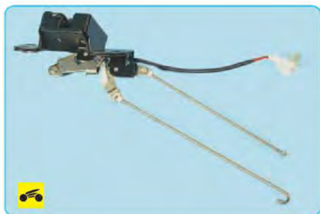
17. Установите замок двери задка и снятые детали в порядке, обратном снятию.
