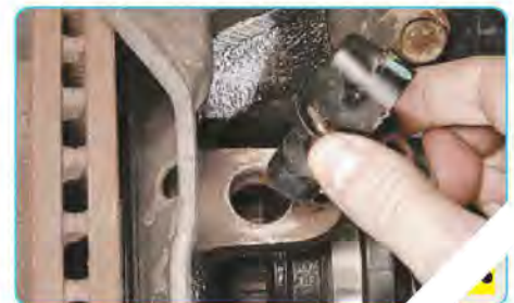
6. ...извлеките датчик из отверстия поворотного кулака и снимите датчик с автомобиля.
