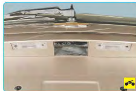
– лампы фонарей освещения номерного знака, тип лампы W5W (5 Вт);
