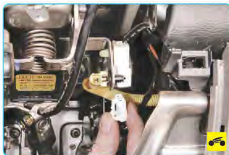
7. Аналогично отсоедините колодку жгута проводов выключателей звукового сигнала.
