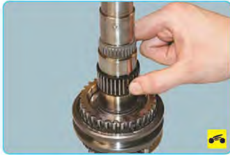
23. ...игольчатый подшипник ведомой шестерни III передачи...
