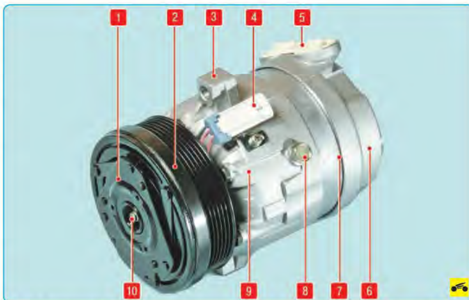
Рис. 12.3. Компрессор кондиционера: 1 – прижимной диск; 2 – шкив привода; 3 – верхняя проушина переднего крепления; 4 – колодка электрического разъема катушки электромагнита; 5 – заглушка фланца крепления трубопроводов; 6 – крышка блока лепестковых клапанов; 7 – блок цилиндров; 8 – пробка отверстия для контроля масла; 9 – передняя крышка корпуса; 10 – гайка крепления прижимной пластины
