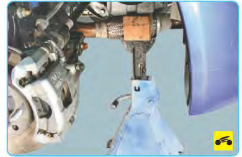
21. Установите опоры под масляный картер двигателя, используя отрезок доски в качестве проставки...
