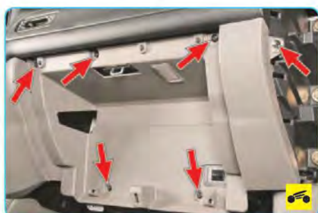
8. Выверните шесть винтов крепления внутренней панели ящика.
