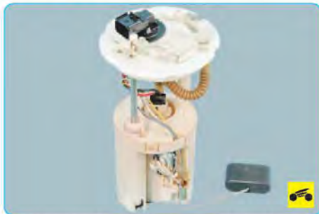
Так выглядит модуль топливного насоса, снятый с топливного бака.
