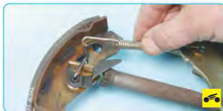
12. Снимите пружину с рычага регулятора зазоров.
