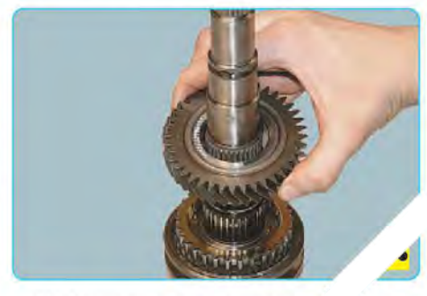
22. Снимите с вала ведомую шестерню III передачи...
