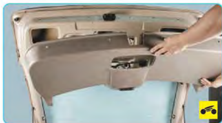
2. Снимите нижнюю облицовку двери задка (см. «Снятие и установка облицовок двери задка», с. 274).
