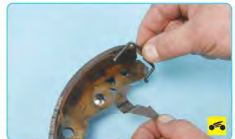
16. ...и серьгу регулятора зазоров с рычагом регулятора зазоров.
