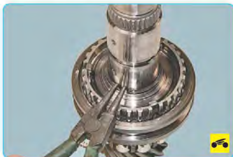
25. Разжав съемником стопорное кольцо ступицы синхронизатора III и IV передач...
