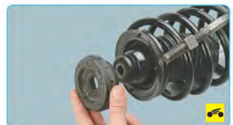
Рис. 7.2. Детали амортизаторной стойки: 1 – гайка штока амортизатора; 2 – верхняя опора стойки; 3 – опорный подшипник; 4 – верхняя опорная чашка; 5 – защитный чехол; 6 – амортизатор; 7 – буфер сжатия; 8 – пружина
