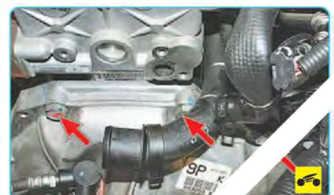
24. Выверните болт крепления картера коробки передач к блоку цилиндров, расположенный сзади около стартера...
