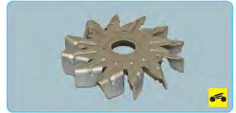
25. Осмотрите крыльчатку вентилятора. На ней не должно быть механических повреждений, все лопасти должны быть расположены под одним углом к плоскости вращения. В противном случае замените крыльчатку.
