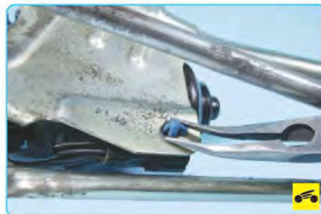
10. Сожмите фиксаторы держателя колодки проводов моторедуктора и выньте держатель из кронштейна.
