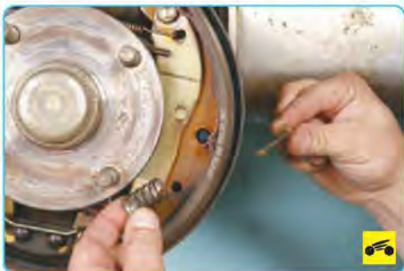
7. ...и снимите чашку крепления прижимной пружины, прижимную пружину и опорную стойку задней тормозной колодки.
