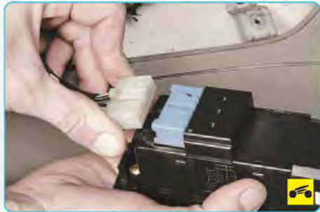
12. ...отсоедините колодку жгута проводов от блока управления электростеклоподъемниками и снимите облицовку вместе с блоком.
