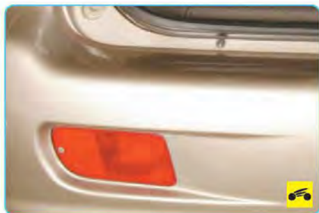
– лампа заднего противотуманного фонаря, тип лампы P21W (21 Вт);
