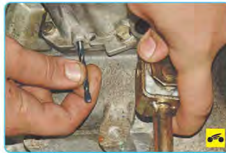
Рис. 6.7. Расположение пробки регулировочного отверстия: 1 – вал переключения передач; 2 – крышка механизма переключения передач; 3 – пробка регулировочного отверстия; 4 – переключатель передач
