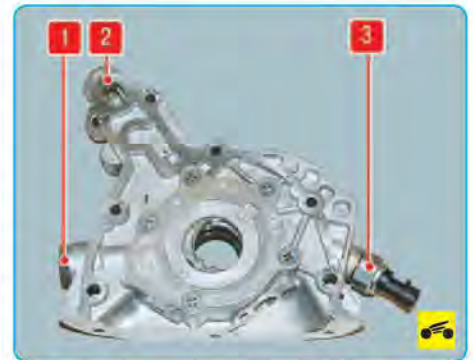
Рис. 5.11. Корпус масляного насоса: 1 – пробка редукционного клапана; 2 – предохранительный клапан; 3 – датчик сигнальной лампы аварийного падения давления масла
