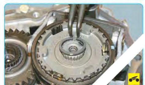
20. ...и направляющую втулку подшипника (см. «Замена сальников коробки передач», с. 145).
