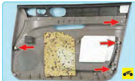
13. Выверните фиксатор пистона на переднем торце двери...
