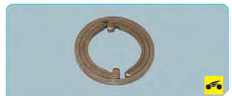
– на упорных полукольцах и запорных цах не должно быть следов износа и трещин на торцевых поверхностях; – на ступицах синхронизаторов не должно быть забоин и следов износа;
