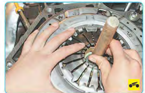
Рис. 6.3. Оправка для центрирования ведомого диска сцепления
