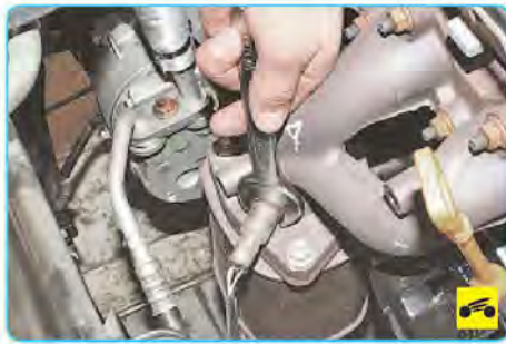
4. Ключом ослабьте затяжку датчика...
