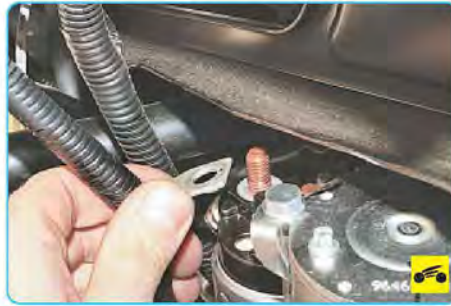
7. ...и отсоедините силовой провод от контактного болта тягового реле стартера.
