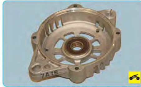
19. Осмотрите крышку со стороны привода. Если обнаружены трещины в крышке, особенно в местах крепления генератора, необходимо заменить крышку новой.
