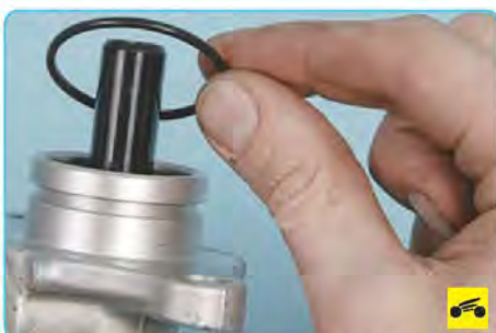
16. ...и снимите кольцо с корпуса главного тормозного цилиндра.
