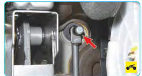
7. Отсоедините от рычага педали управления дроссельной заслонкой, наконечник троса...
