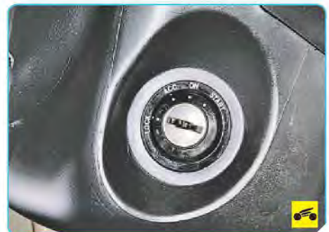
28 – выключатель (замок) зажигания, объединенный с противоугонным устройством, расположен с правой стороны левой колонки. Ключ в замке может закрывать одно из четырех положений:
