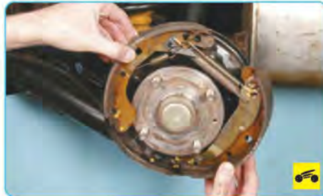
10. Снимите тормозной механизм заднего колеса в сборе с передней и задней колодками и регулировочным механизмом...
