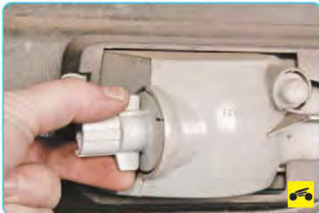
1. Поверните патрон лампы против часовой стрелки...
