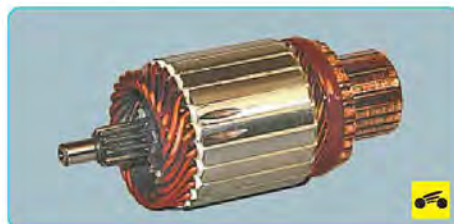
24. Осмотрите ротор. На шестерне и цапфах вала ротора не должно быть повреждений (забоины, задиры). На коллекторе ротора не должно быть следов обгорания. Незначительное обгорание устраните ветошью, смоченной в бензине, и мелкозернистой наждачной шкуркой.
