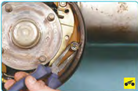
6. Прижмите пассатижами пружину и чашку крепления прижимной пружины к задней тормозной колодке, поверните на четверть оборота опорную стойку...
