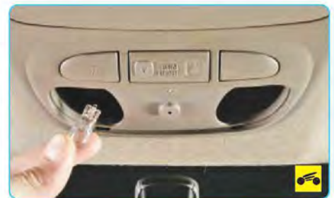
4. Извлеките лампу. 5. Вставьте новую лампу. 6. Установите рассеиватель в корпус плафона до щелчка (защелкивания фиксаторов).
