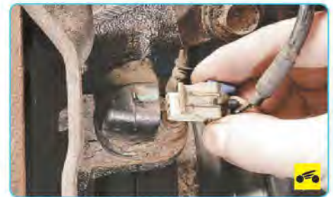
4. ...и отсоедините колодку жгута проводов от датчика частоты вращения переднего колеса.
