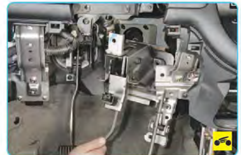
8. ...и снимите педальный узел в сборе со шпильки вакуумного усилителя тормозов и щита передка.
