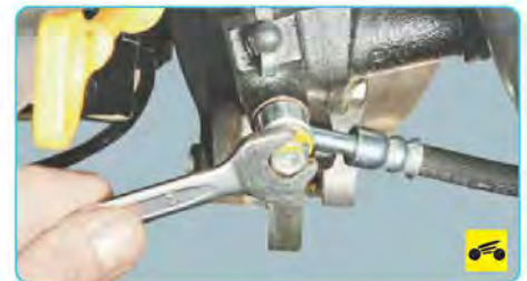
14. Выверните болт-штуцер крепления шланга к рабочему цилиндру привода выключения сцепления...
