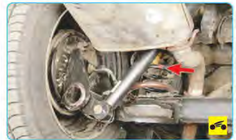
Рис. 7.3. Расположение элементов задней подвески на автомобиле: 1 – пружина задней подвески; 2 – верхняя прокладка пружины; 3 – амортизатор; 4 – кулак; 5 – балка задней подвески
