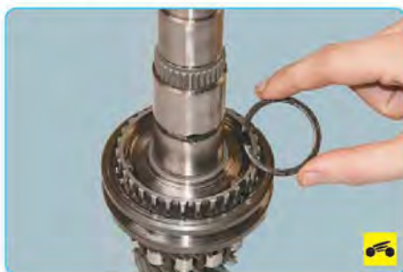
26. ...снимите с вала стопорное кольцо...
