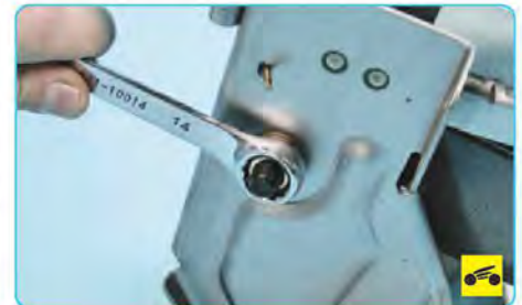
9. Удерживая ключом болт от проворачивания, вторым ключом отверните гайку...
