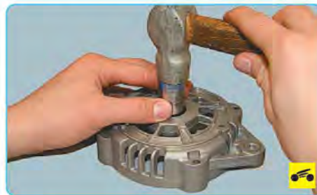
21. Для замены переднего подшипника вала ротора выпрессуйте его из крышки.
