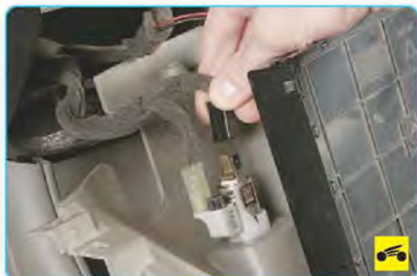
12. ...отсоедините колодку жгута проводов прикуривателя.
