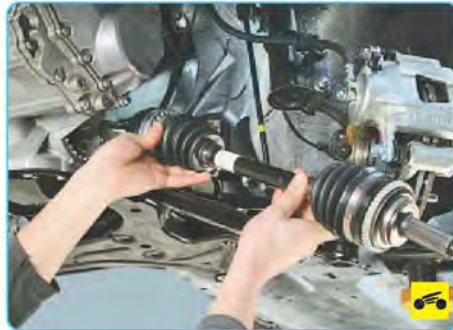
17. Снимите приводы передних колес (см. «Снятие и установка приводов передних колес», с. 164).
