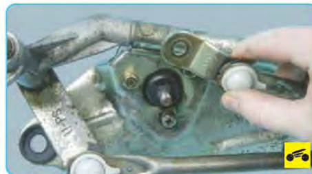
9. ...и снимите кривошип, пометив или запомнив его расположение на валу моторедуктора для корректной установки.
