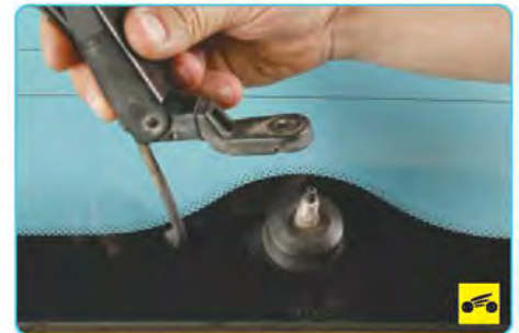
9. ...и снимите кривошип, пометив или запомнив его расположение на валу моторедуктора для корректной установки.
