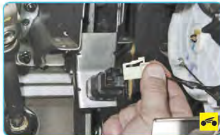
3. Отсоедините от выключателя стоп-сигнала тормоза колодку жгута проводов, сжав фиксаторы (см. «Замена датчиков и выключателей», с. 254).
