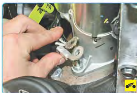
11. ...и снимите со шпильки жгуты проводов «массы».
