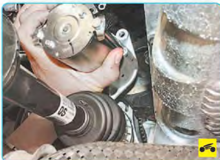
15. Снимите стартер (см. «Снятие и установка стартера», с. 222).
