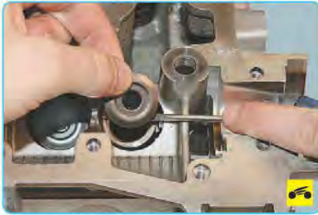
18. Поддев отверткой, снимите тарелку пружины клапана...
