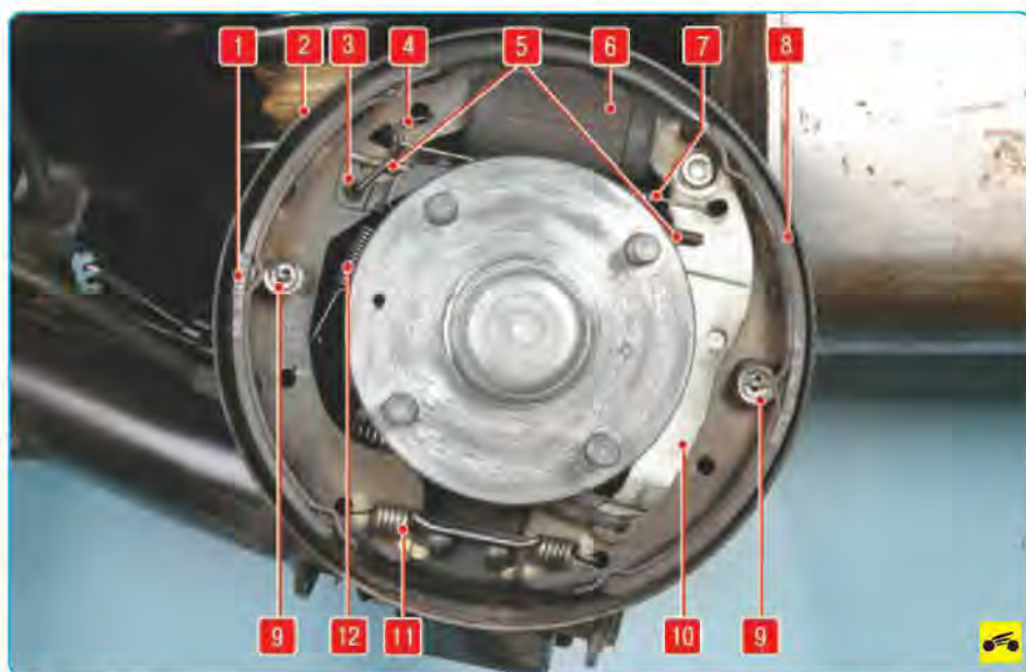
Рис. 9.3. Тормозной механизм заднего колеса: 1 – передняя тормозная колодка; 2 – щит тормозного механизма; 3 – рычаг регулятора зазора; 4 – серьга регулятора зазора; 5 – распорная планка; 6 – рабочий цилиндр; 7 – верхняя стяжная пружина; 8 – задняя тормозная колодка; 9 – опорные стойки; 10 – разжимной рычаг стояночного тормоза; 11 – нижняя стяжная пружина; 12 – пружина механизма автоматической регулировки зазора между колодками и барабаном
