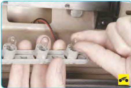
6. Установите новую лампу в патрон. 7. Установите снятые детали в последовательности, обратной снятию.
