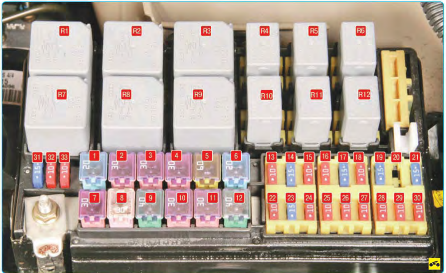
Рис. 10.2. Номера плавких вставок, предохранителей и реле в монтажном блоке, расположенном в моторном отсеке
