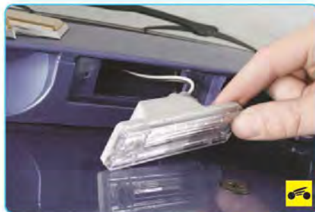
2. Снимите фонарь освещения номерного знака (см. «Замена фонарей освещения номерного знака», с. 242).
