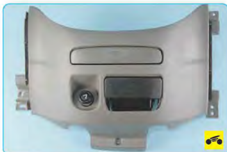
16. Снимите центральную облицовочную накладку панели приборов.
