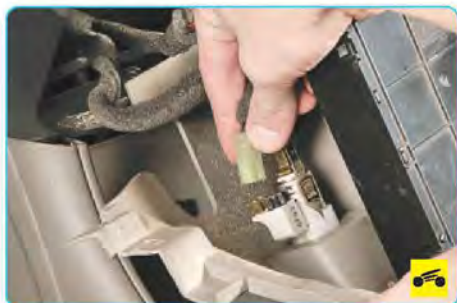
13. Аналогично отсоедините колодку жгута проводов лампы подсветки прикуривателя.
