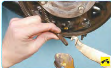
11. ...отсоедините наконечник троса стояночного тормоза от разжимного рычага.
