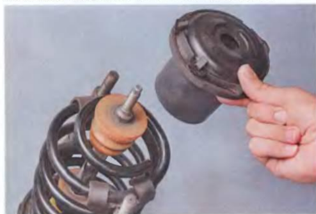
8. Снимаем буфер хода сжатия.
