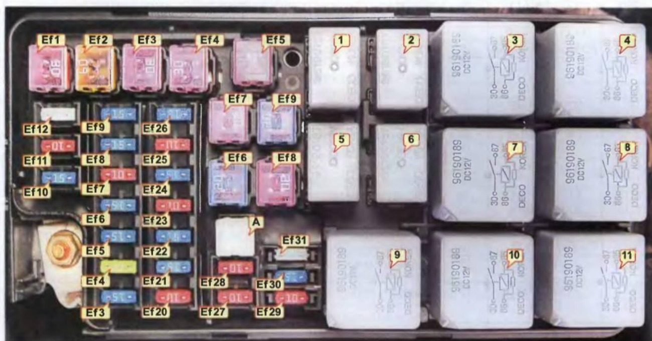
Блок предохранителей и реле, установленный в моторном отсеке
