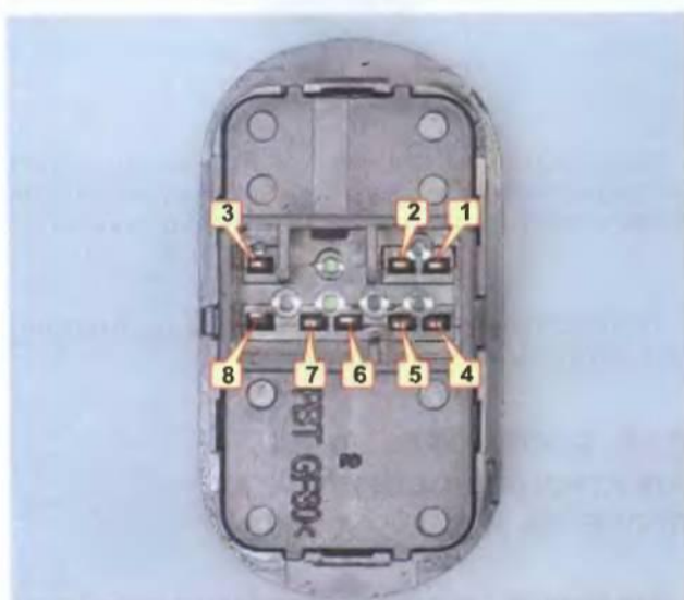
Номера выводов блока управления электроприводом зеркал
