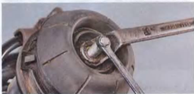
5. Снимаем верхнюю опору стойки.
