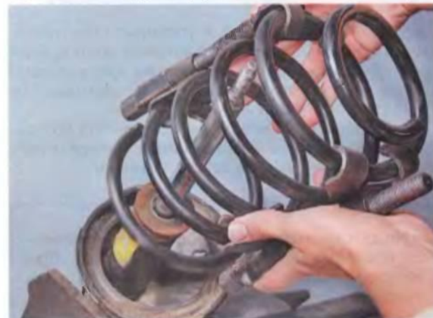
10. Снимаем с нижней чашки пружины резиновую прокладку.
