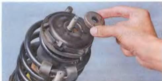
6. Снимаем со штока амортизатора упорный подшипник.
